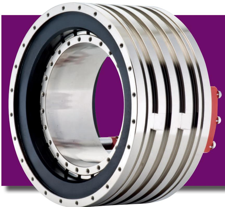
**I** motori *direct drive*, o a trazione diretta, sono in grado di azionare un carico direttamente, anche senza organi di trasmissione, e sono dotati di un'ottima dinamicità di risposta. Grazie a un sistema di movimento senza punti di contatto, essi non sono soggetti né a usura né a gioco; sono pertanto dotati di precisione e ripetibilità molto elevate, nonché di altri vantaggi quali facilità di manutenzione e intervalli di manutenzione più lunghi.
