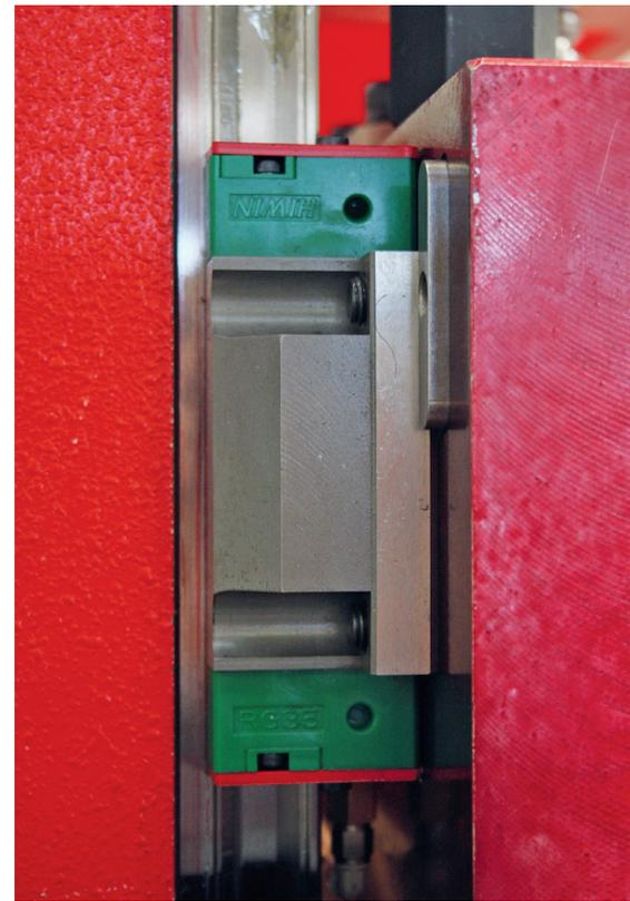
**Guida lineare a rulli RG 35 di Hiwin montata sulla linea di piegatura Cosma.**
